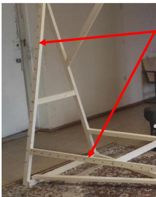
На вертикальной и горизонтальной части станка размещаются крепления для дели (сети)
