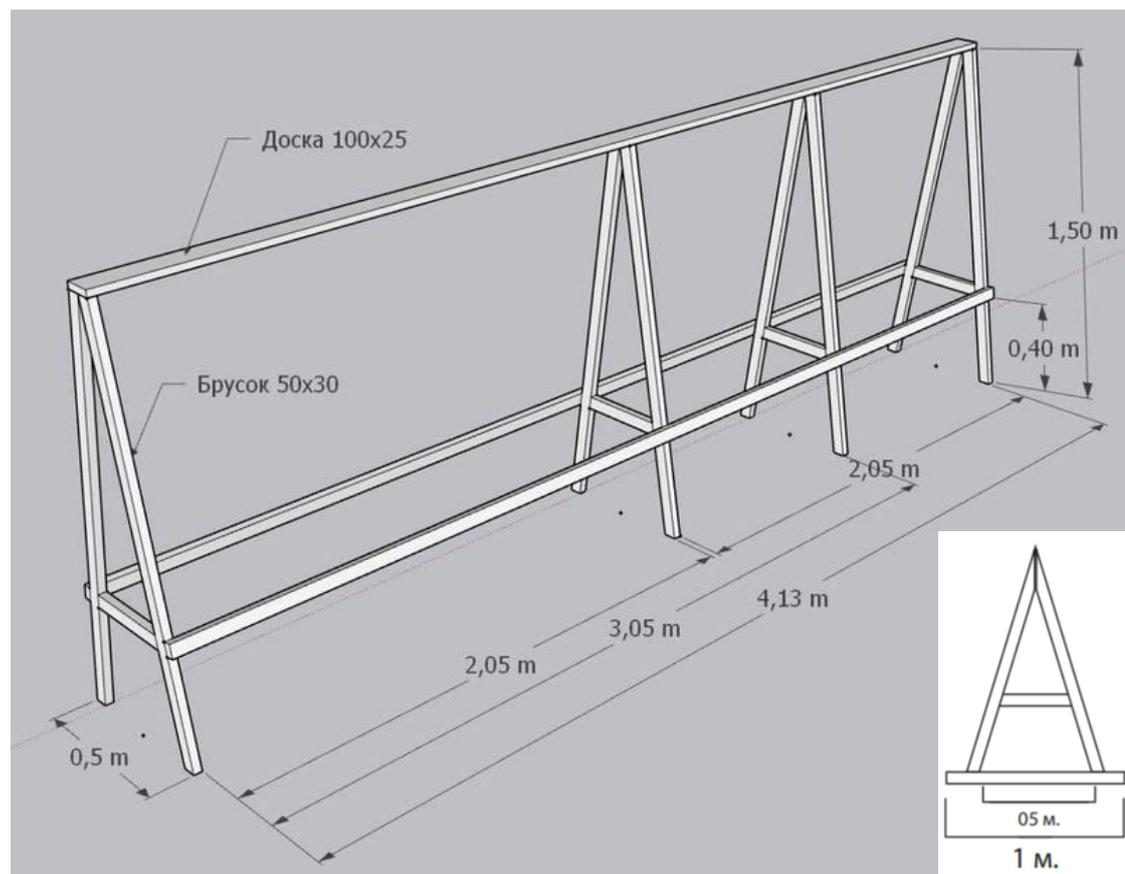
Наиболее часто можно встретить станки под размер сетки 3х2метра. При этом высота станка будет 1,5м. и длина станка 3,1м (5см справа и слева требуются для крепления основы - дели). Пример собранного станка можно увидеть на фото1 (предоставлено волонтерами ОНФ).
